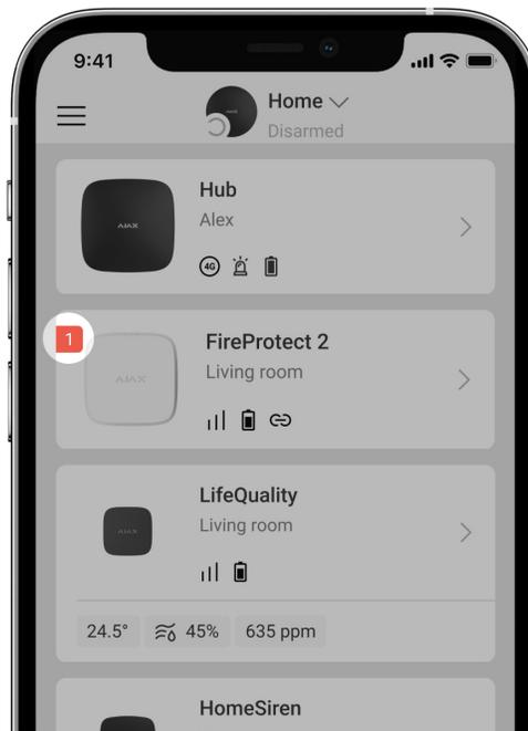
Wird eine Störung von FireProtect 2 festgestellt (z. B. keine Verbindung mit der Hub-Zentrale), wird ein Störungszähler im Feld des Geräts in den Ajax-Apps angezeigt.
