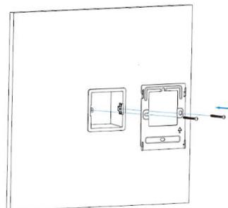
Befestigen Sie die Wandhalterung auf der UP-Schalterdose mit zwei M4X30 Schrauben.
