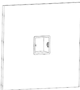
Vergewissern Sie sich, dass sich alle Kabel in der UP-Schalterdose befinden.
