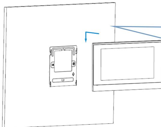
Hängen Sie die IS313 auf die Wandhalterung und drücken Sie nach unten, bis diese einrastet.
