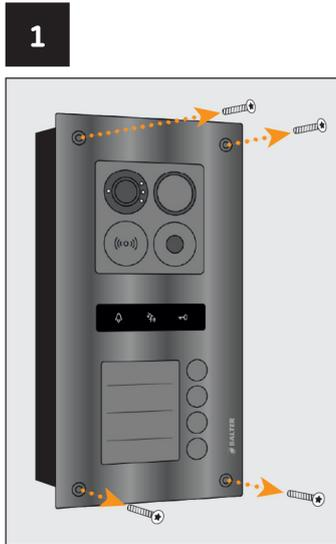
Entfernen Sie alle Befestigungsschrauben.
